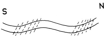
Fig. 8. — Pli synclinal avec clivage schisteux sur un seul flanc
